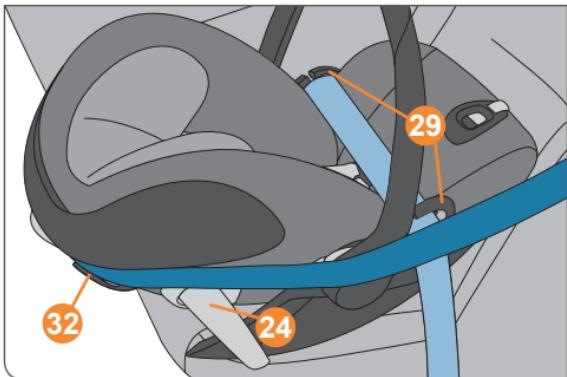
**! ATTENTION !** Dans certains cas, la boucle de la ceinture du véhicule est trop longue et atteint les guides de ceinture bleus de la coque. De ce fait, le siège auto ne peut pas être fixé fermement. Dans ce cas, choisissez une autre position dans la voiture pour installer le siège auto. En cas de doute, contactez le fabricant du siège auto.
